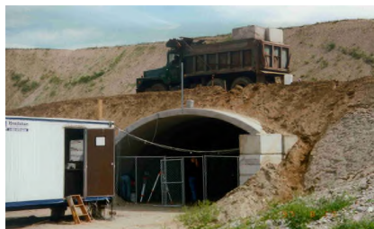
BEBO-Grossversuch in den USA, im Rahmen des "Large Span Culvert Field Test Program" (Massachusetts, 1997).
